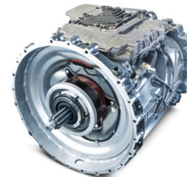
По сравнению с предыдущим поколением роботизированная коробка передач HI-TRONIX была доработана. Время переключения передач сократилось на 10%.
