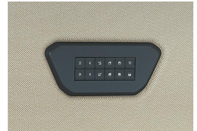
Управление системами комфорта и запирания прямо из зоны отдыха автомобиля: освещение, отопление, аудиосистема, замки дверей и др.
