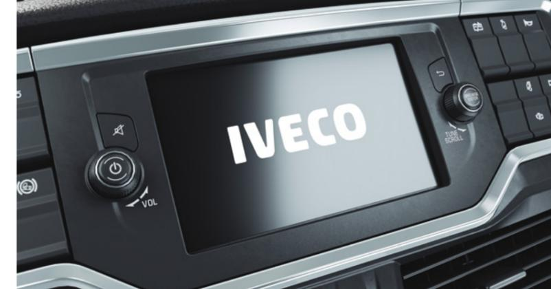
Мультимедийная система с 7-дюймовым сенсорным дисплеем и с возможностью сопряжения с мобильными устройствами при помощи сервисов Apple Car Play или Android Auto.
