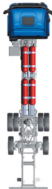
Баллоны для КПГ на раме в сочетании: • С правой стороны: с баллонами для КПГ; с левой стороны: с баллонами для КПГ. • С правой стороны: с баллонами для КПГ; с левой стороны: без баллонов. • С правой стороны: без баллонов; с левой стороны: с баллонами для КПГ.
