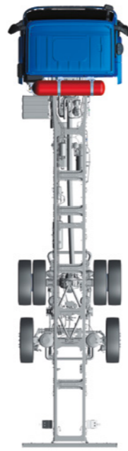
Баллоны для КПГ позади кабины в сочетании: • С левой стороны: с баллоном для КПГ; с правой стороны: с баллоном для КПГ. • С левой стороны: с баллоном для КПГ; с правой стороны: без баллонов. • С левой стороны: без баллонов; с правой стороны: с баллоном для КПГ.
