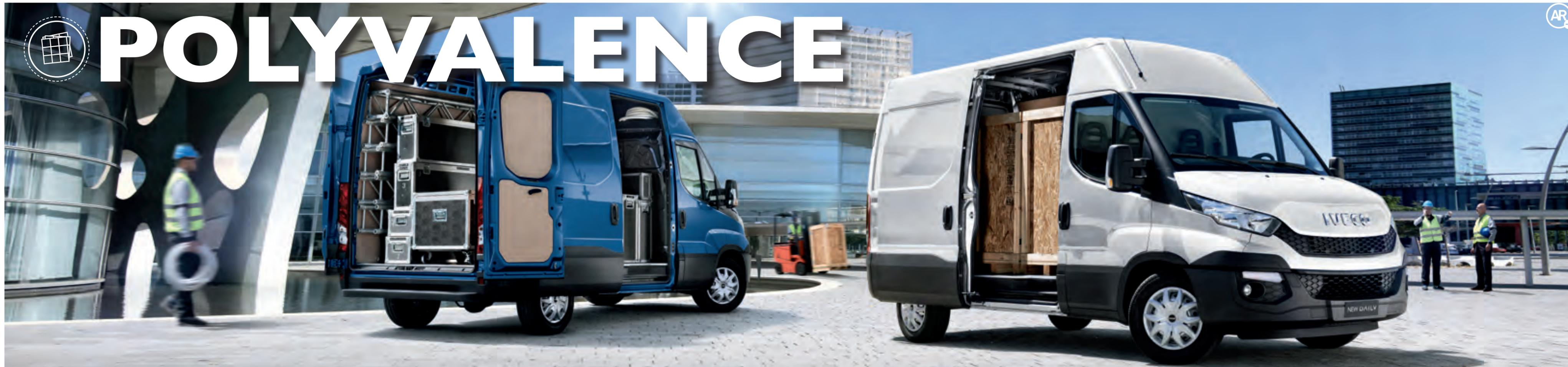
Le **Nouveau DAILY** est le véhicule le plus polyvalent de sa catégorie, avec des PTAC de 3,3 à 7 tonnes et des volumes de chargement de 7 à 20 m<sup>3</sup>. Dès le nouveau modèle de 11 m<sup>3</sup> on peut charger des Europalettes 1200 x 800 mm par les portes arrière et la (ou les) porte(s) latérale(s). Le fourgon est proposé en trois hauteurs : 1545, 1900 et 2100 mm pour permettre de se déplacer debout dans l'espace de chargement. Les longueurs du véhicule s'étendent de 5040 à 7500 mm et
