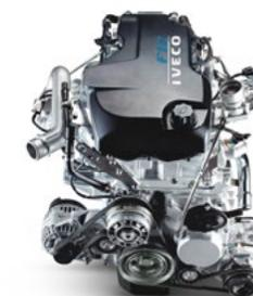
Motor de Gas Natural Comprimido
