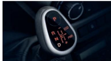
데일리 전용 Hi-Matic 8단 자동 변속기는 전 차량에 적용 가능하며 편안함, 안전, 연비 및 성능의 모든 이점을 제공합니다. 에코모드와 파워모드의 적절한 사용으로 뛰어난 연료경제성을 실현하며 변속 프로그램은 200밀리초 이내에 적절한 기어가 부드럽게 체결되도록 합니다. 폭넓은 기어비는 엔진이 최적의 기어로 작동하는 것을 의미합니다.
