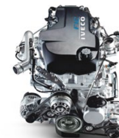
Motor FIC de 3,0 litros a gás natural comprimido
