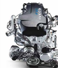
3,0-litrowy silnik FIC na sprężony gaz ziemny
