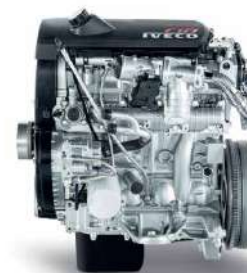
2,3-litrowy silnik diesla FIA z układem SCR
