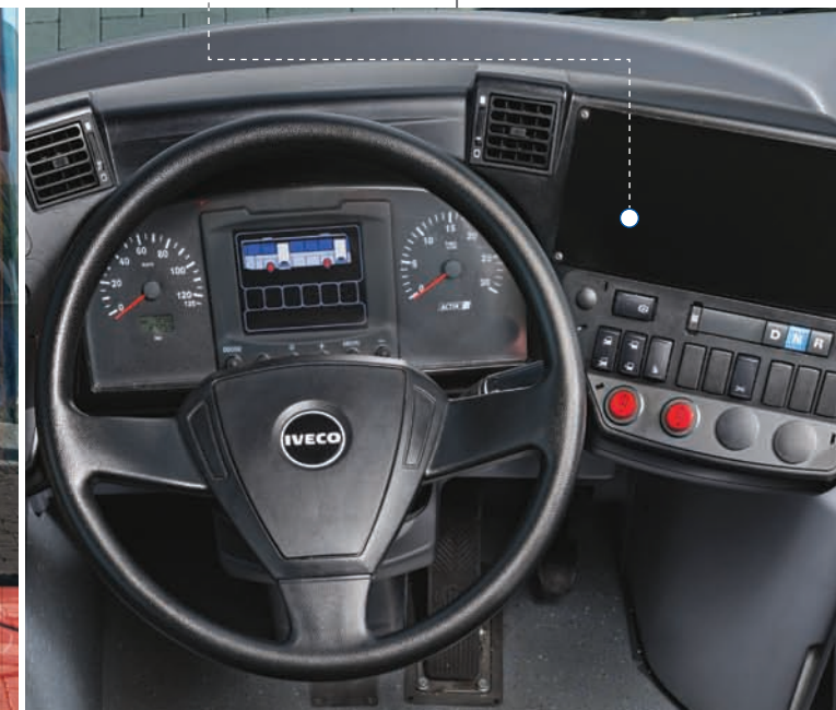
Spazio dedicato al terminale di sistema dell'operatore (specifiche VDV/EBSF)
