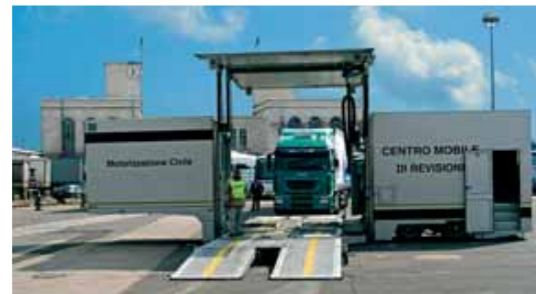
Un "Centro Mobile di Revisione" utilizzato sulle principali vie di comunicazione stradali e autostradali per controllare la perfetta efficienza dei veicoli industriali
