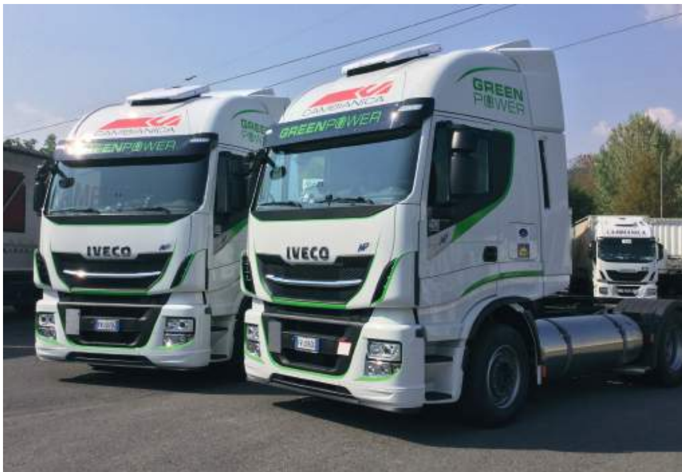
Sopra, gli Stralis Natural Power con motorizzazione Cursor 13 a gas naturale liquefatto, consegnati alla Autotrasporti Cambianica
