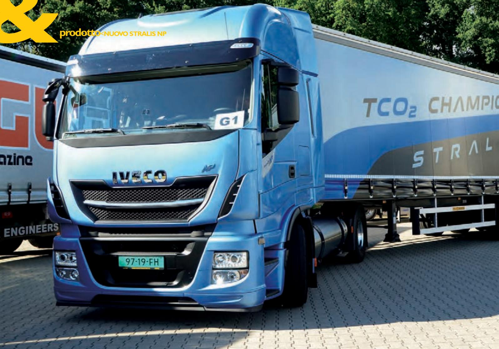
**Autonomia operativa fino a 1.500 km, stessa capacità di carico di un camion diesel, costi di gestione ridotti fino al 7%, comfort, silenziosità di marcia e basso impatto ambientale per il Nuovo Stralis Natural Power con motore a gas da 400 Cv e cambio automatizzato Eurotronic**
