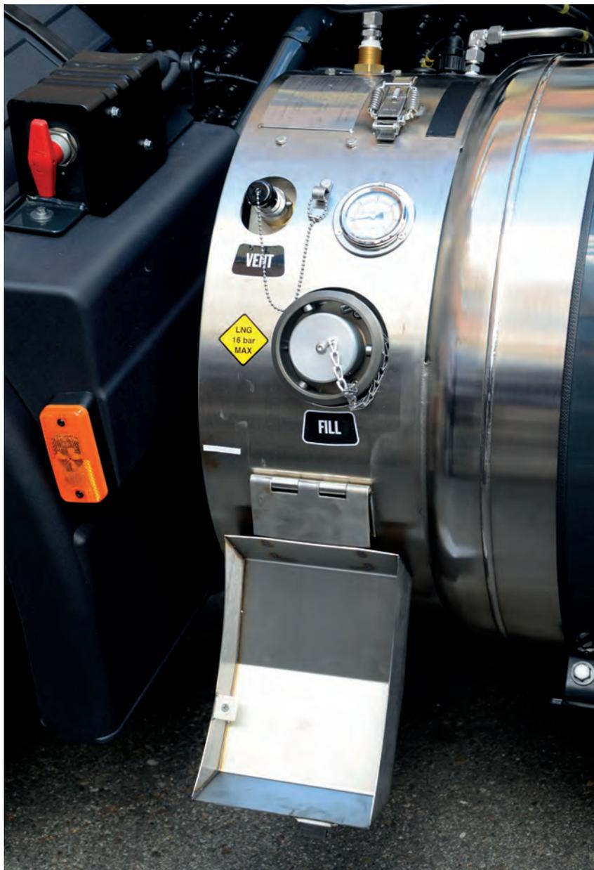
Sopra, il bocchettone del serbatoio criogenico da 540 litri per il gas naturale liquefatto (LNG)
