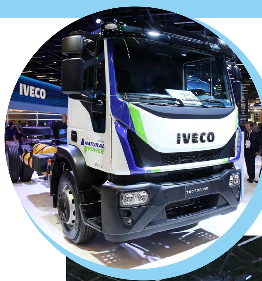
En su versión rígida y configuración 4x2 cabina corta, este vehículo cuenta con seis tanques de GNC, cada uno con una capacidad de 80 litros, que otorga una autonomía aproximada entre 300 y 400 kilómetros (dependiendo de la carga y modo de conducción). Ofrece potencia y bajo nivel de emisiones gaseosas y sonoras, convirtiéndose en el producto ideal para tareas urbanas y misiones nocturnas.
