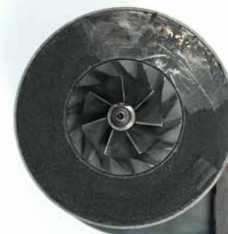
Turbina a geometria variabile sottoposta a test di usura con l'utilizzo di lubrificante non raccomandato
