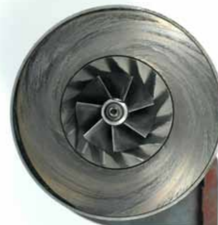
Turbina a geometria variabile sottoposta a test di usura con l'utilizzo di prodotto PETRONAS Urania
