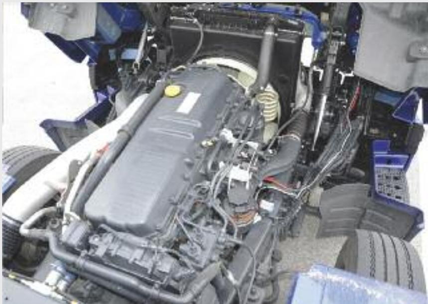
Sopra, il Cursor 11 a sei cilindri in linea 11,1 litri da 480 cavalli. Sotto, da sinistra a destra, l'isolamento termo-acustico della cabina di guida, il lato destro del motore, la pompa del sistema d'iniezione common rail e la ventola del radiatore frontale. In basso, da sinistra, il collettore dell'aria, il turbocompressore a geometria variabile, uno dei supporti della cabina e le sospensioni posteriori.
