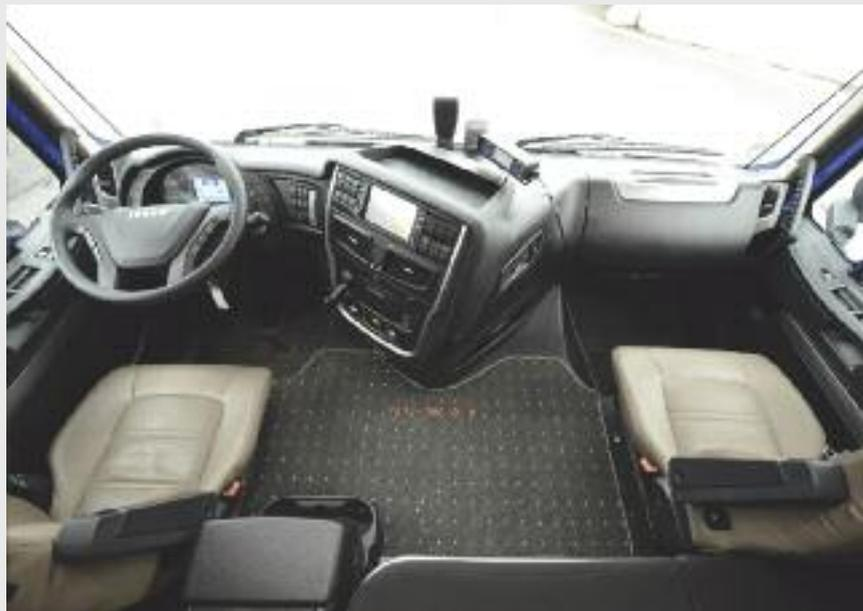
Sopra, una panoramica dell'abitacolo dello Stralis. Sotto, da sinistra a destra, il volante e il cluster strumenti, i pulsanti di comando del cambio automatizzato AsTronic e il display da 7 pollici del sistema Iveconnect, che gestisce la navigazione, l'infotracimento e le funzioni di fleet management. In basso, da sinistra la botola, il lettini, i vani portaoggetti, il frigo e la brandina inferiore sollevata.
