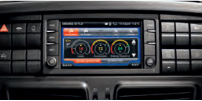
CIASCUN INDICE È PRESENTATO ALL'UTENTE IN TEMPO REALE CON UN INDICATORE ANALOGICO AL CENTRO DEL QUALE VIENE RIPORTATO IL VALORE PERCENTUALE: PIÙ ALTO È IL VOTO, MIGLIORE LA GUIDA DAL PUNTO DI VISTA DEL RISPARMIO DI CARBURANTE.
