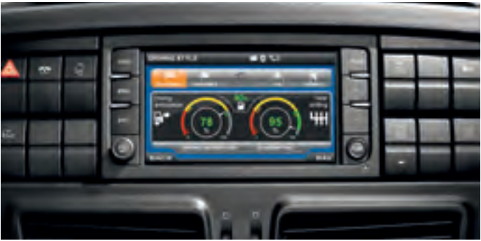
DRIVING STYLE EVALUATION: IL SISTEMA ELABORA I DATI ACQUISITI DA MOTORE, VEICOLO E GPS ATTRAVERSO UN ALGORITMO AVANZATO (SVILUPPATO DA IVECO) CHE VALUTA LA PERFORMANCE DEL CONDUCENTE DAL PUNTO DI VISTA DEL RISPARMIO DI CARBURANTE. LA VALUTAZIONE SI BASA SU UN INSIEME DI INDICI, STRUTTURATI SECONDO UN ALBERO A TRE LIVELLI, CHE TENGONO CONTO DELLA DIFFICOLTÀ DELLA MISSIONE.
