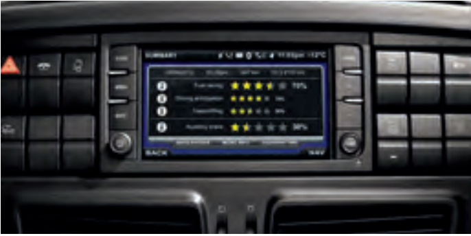
AL TERMINE DI OGNI VIAGGIO, IL CONDUCENTE PUÒ VISUALIZZARE SULLO SCHERMO UN RIEPILOGO DI TUTTI GLI INDICI DI PERFORMANCE , ESPRESSI IN PERCENTUALE E SINTETIZZATI IN FORMA GRAFICA.
