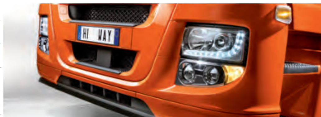
PARAURTI OTTIMIZZATO PER MIGLIORARE L'AERODINAMICA
