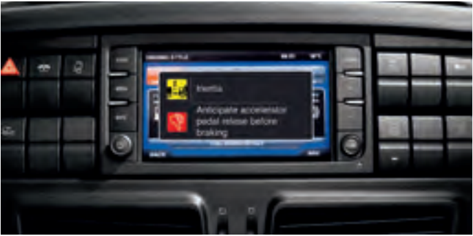
DURANTE LA MARCIA, SULLO SCHERMO IVECONNECT COMPAIONO ANCHE SUGGERIMENTI PER LA RIDUZIONE DEI CONSUMI (CHE RIGUARDANO L'USO DEL CAMBIO, DEL FRENO, DEL FRENO MOTORE, LE ACCELERAZIONI E LO SFRUTTAMENTO DELL'INERZIA).
