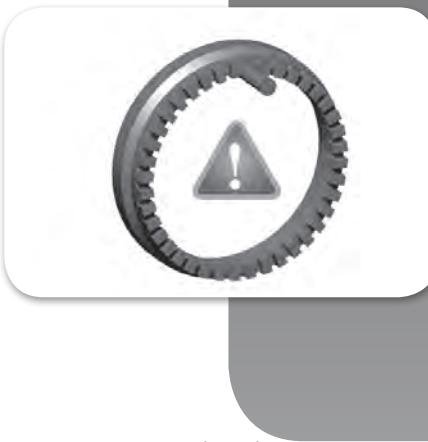
**¡Atención!** Cuando se desmonten las ruedas se debe prestar mucha atención para evitar dañar los sensores. La distancia entre la rueda fónica y los sensores no debe ser modificada, ya que se vería alterado el normal funcionamiento del sistema. El encendido de los señalizadores luminosos con la llave de contacto y arranque en la posición de pre arranque y por algunos instantes después del arranque del motor no indica anomalía, es una función normal de control del sistema.
