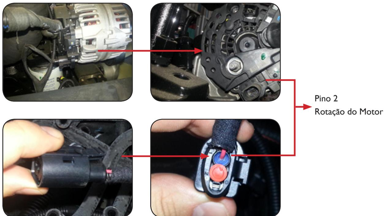
É necessário desmontar o conector, remover o tampão da cavidade 2 e conectar o cabo adequado fixado no terminal.
