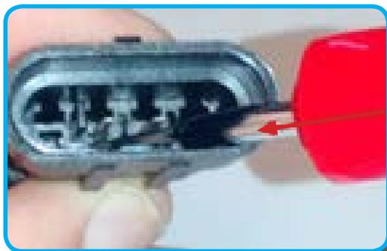
Com a ferramenta adequada (punção) destravar para remover os terminais
