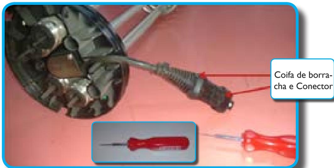
Repetir o procedimento, com a ferramenta adequada (punção) destravar para remover os terminais e retirar a coifa de borracha.
