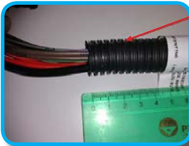
Cortar e remover 30 mm ou 7 espiras do forro corrugado de diâmetro 17 mm desde a extremidade do conector Dnox
