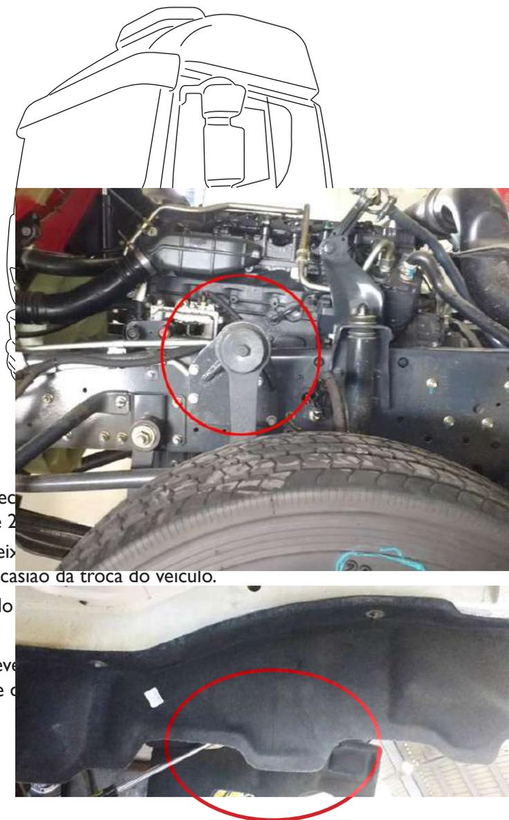
O segundo eixo direcional é instalado no veículo para permitir o carregamento de 2 toneladas por eixo, tornando-os aptos para as condições originais por ocasião da troca do veículo.
