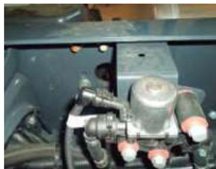
13. Remova o suporte o encaixe indicado na figura, localizado no motor.
