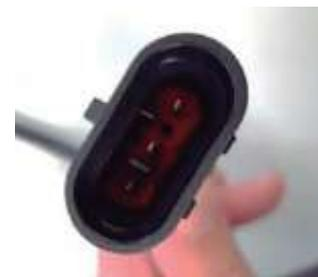
O conjunto de tubos (item 20 PN 5801347642), deve substituir o cabo com conector de 3 pinos por um cabo com conector de 4 pinos.
