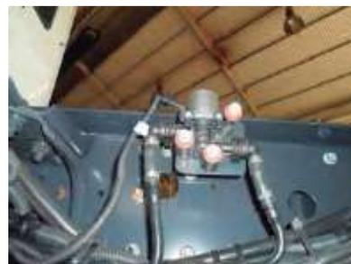
Remova as vedações do maço do chicote elétrico. Encontre o terminal predisposto (78267) e conecte na válvula.
