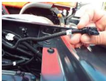
Remova as vedações do maço do chicote elétrico. Encontre o terminal padrão de fábrica (78267) e conecte a válvula.
