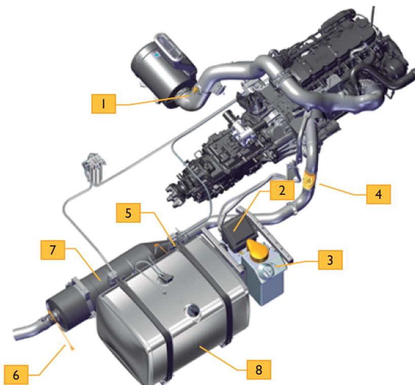
1. Sensor para detecção de umidade do sistema de admissão. Localizado no duto do filtro de ar localizado no lado esquerdo do veículo.
