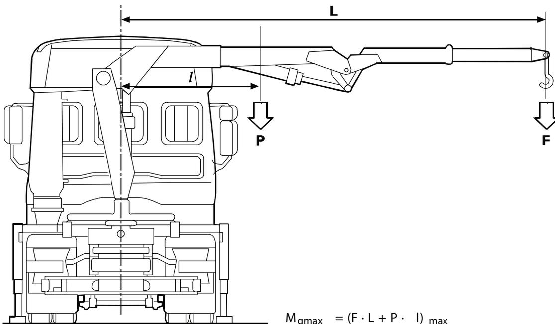
As dimensões do chassi auxiliar referem-se ao momento máximo estático total da grua ( $M_{gmax}$ ), que é calculado com base da equação dada na figura acima.
