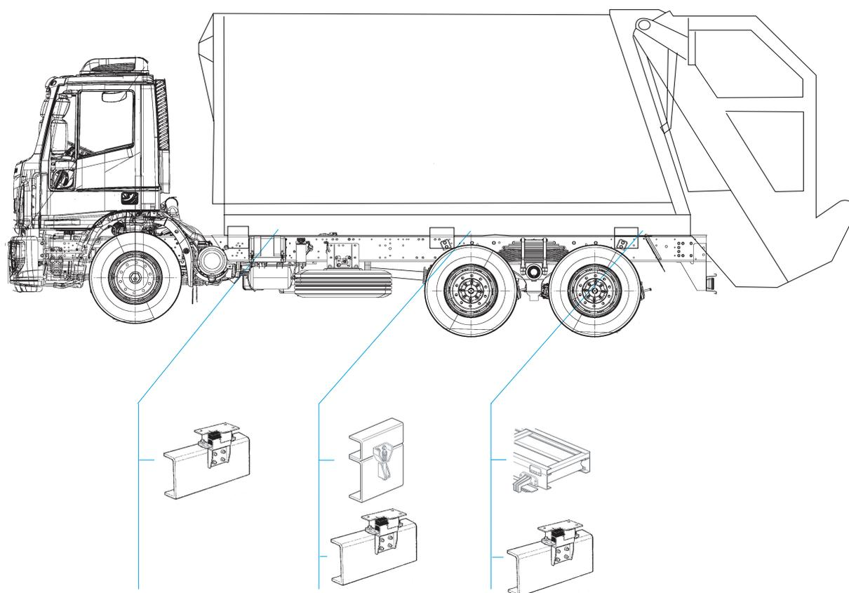
As conexões utilizadas na estrutura do chassi e do chassi auxiliar devem ser escolhidas de acordo com as condições das estradas em que o veículo irá operar.
