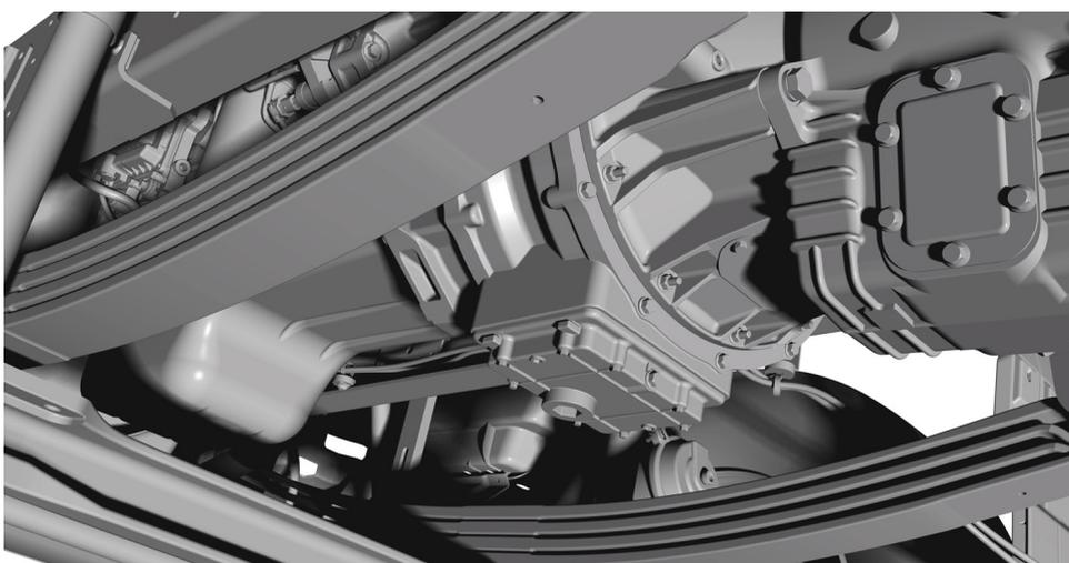
Tomada de força, também conhecida pela sigla **PTO** (do termo na língua inglesa *power take-off*) é um eixo propulsor, disponível em maquinário pesado, usado para transferir força mecânica do motor a um implemento instalado. Diferentes tipos de PTO podem ser usados dependendo do tipo de uso e os desempenhos requeridos.
