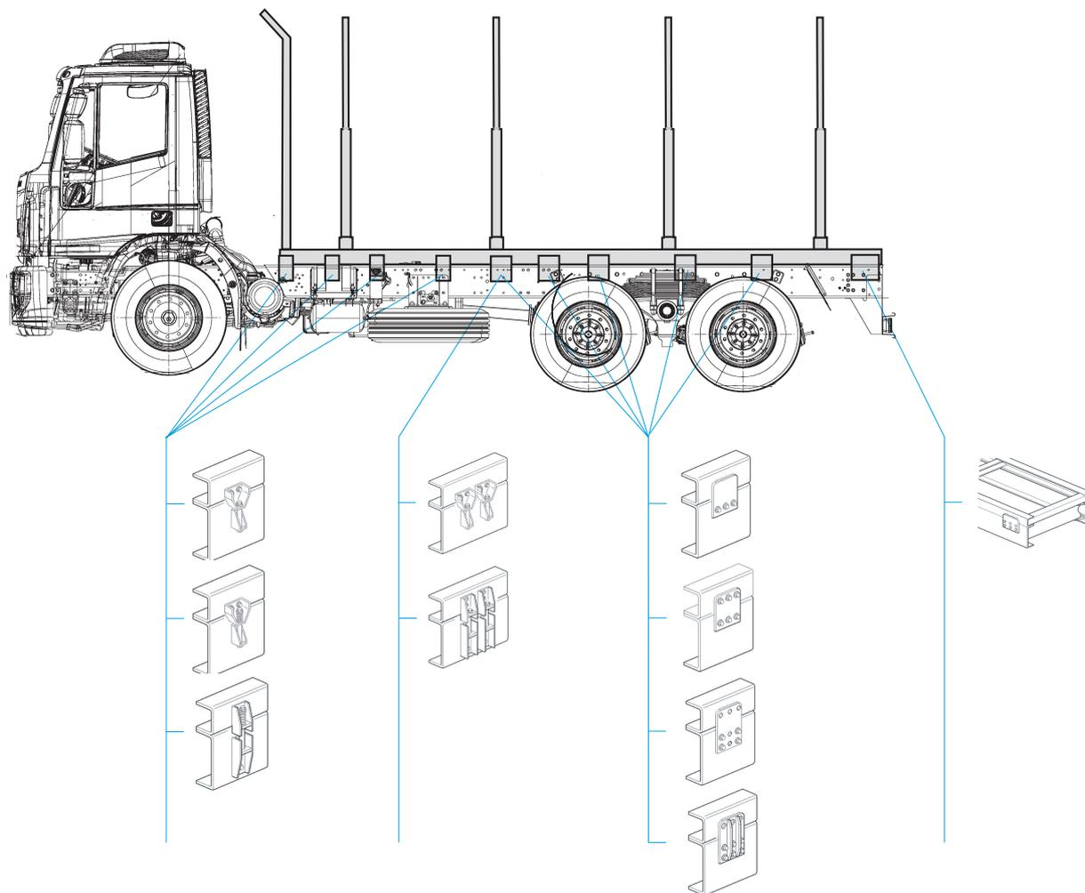
As conexões utilizadas na estrutura do chassis e do chassis auxiliar devem ser escolhidas de acordo com as condições das estradas em que o veículo irá operar.
