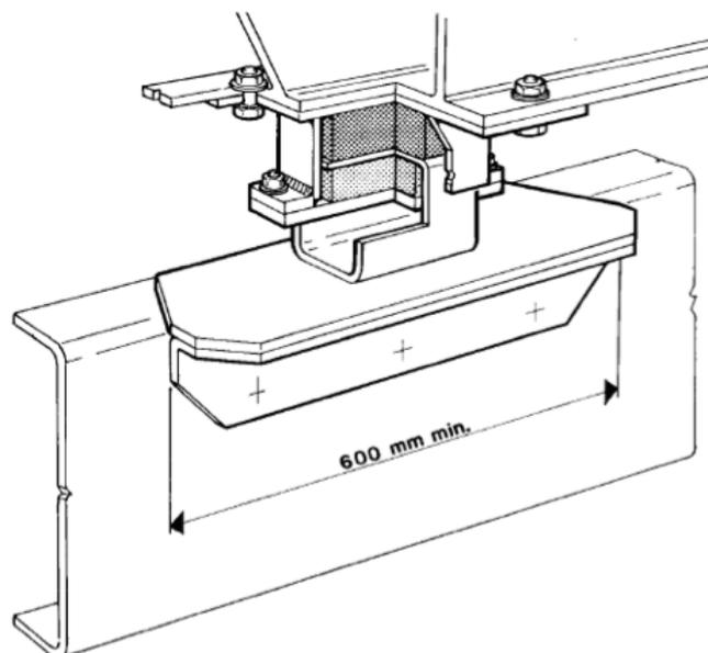
A instalação de dois ou mais containers ou tanques no veículo requer a utilização de chassi auxiliar, que permita uma boa distribuição da carga e uma rigidez torcional adequada para o chassi/chassi auxiliar utilizando conexões resistentes. Uma boa solução é constituída por meio de uma conexão rígida que liga os containers juntos.
