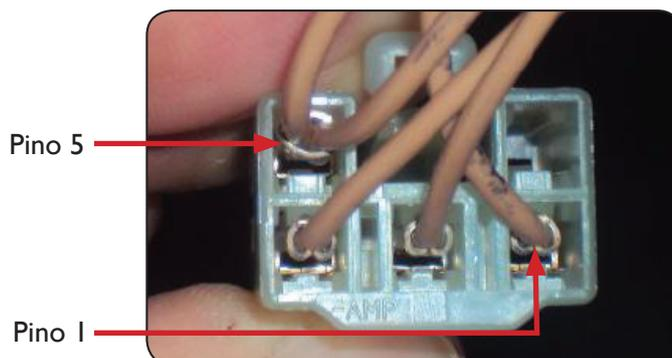
Vista da entrada de cabos no conector das resistências para adequação de velocidade do motor à função PTO
