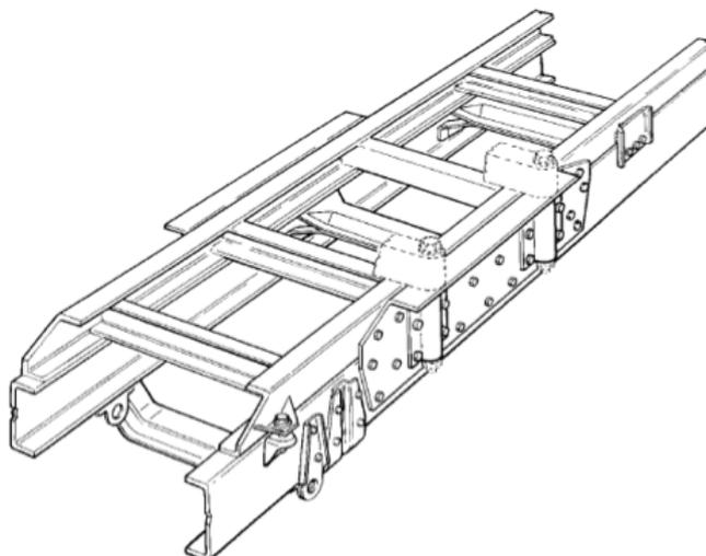
Ao instalar guindastes em veículos de cabine longa, com impossibilidade de estender o chassi auxiliar até o suporte traseiro da mola, pode ser necessário conter a rotação do guindaste de acordo com sua capacidade, de modo a não exceder o momento fletor para o chassi.
