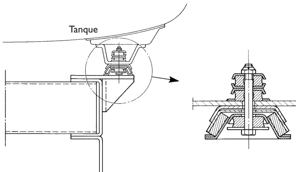
As conexões rígidas posicionadas sobre os suportes da suspensão traseira são as mais adequadas para a transmissão das forças diretamente para os elementos de suspensão. As ligações flexíveis são posicionadas sob o suporte traseiro da parte dianteira da suspensão.
