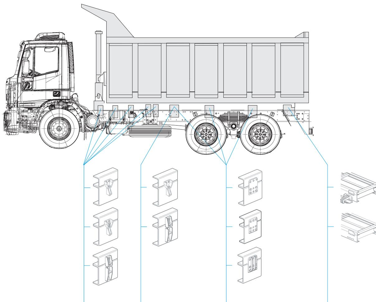
As conexões utilizadas na estrutura do chassi e do chassi auxiliar devem ser escolhidas de acordo com as condições das estradas em que o veículo irá operar.
