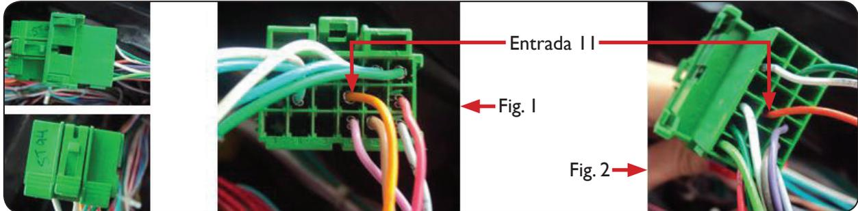
O sinal deve ser retirado no conector fêmea indicado na figura 2 (desconectando e isolando corretamente o cabo laranja). Caso o conector fêmea não esteja disponível, o sinal pode ser retirado do conector macho, cabo laranja, indicado na figura 1.
