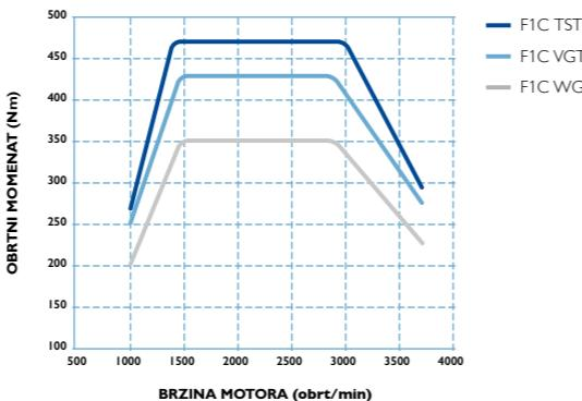
VGT: Turbokompresor varijabilne geometrije; WG: Odvod; TST: Turbokompresor sa dvostrukim stepenom
