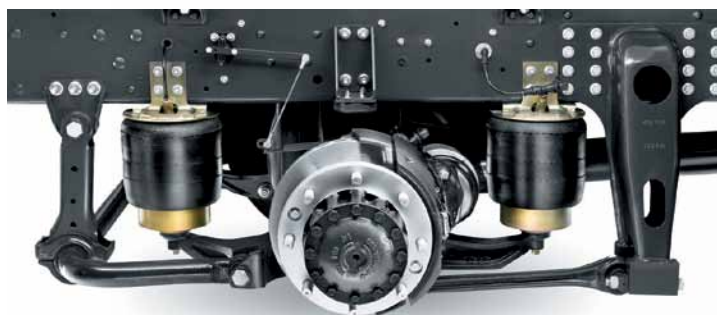
Задняя пневмоподвеска с 4 пневмоэлементами для версий от 15 до 18 т
