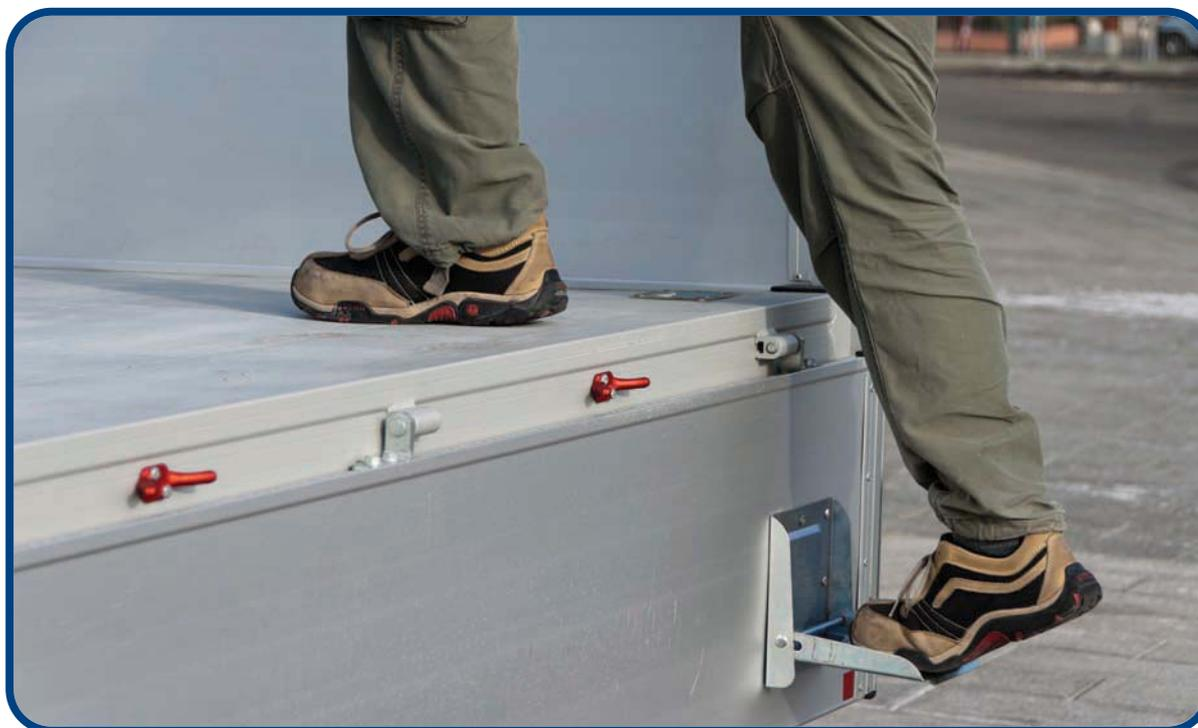
**L'accesso a bordo dal lato posteriore è facilitato da un gradino ripiegabile fissato alla superficie liscia interna della sponda posteriore. Sollevando la sponda, il gradino si richiude evitando così di danneggiare la merce.**
