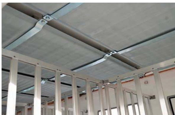
**Sopra, a soffitto, le cinque piastre eutettiche immagazzinano il freddo per poi rilasciarlo lentamente durante la giornata di lavoro, rendendo inutile un compressore sempre in funzione.**
