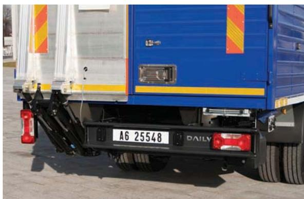
Sopra, il particolare del gruppo ottico posteriore lato guida in posizione verticale, soluzione che facilita l'escursione della sponda con piattaforma in lega leggera.
