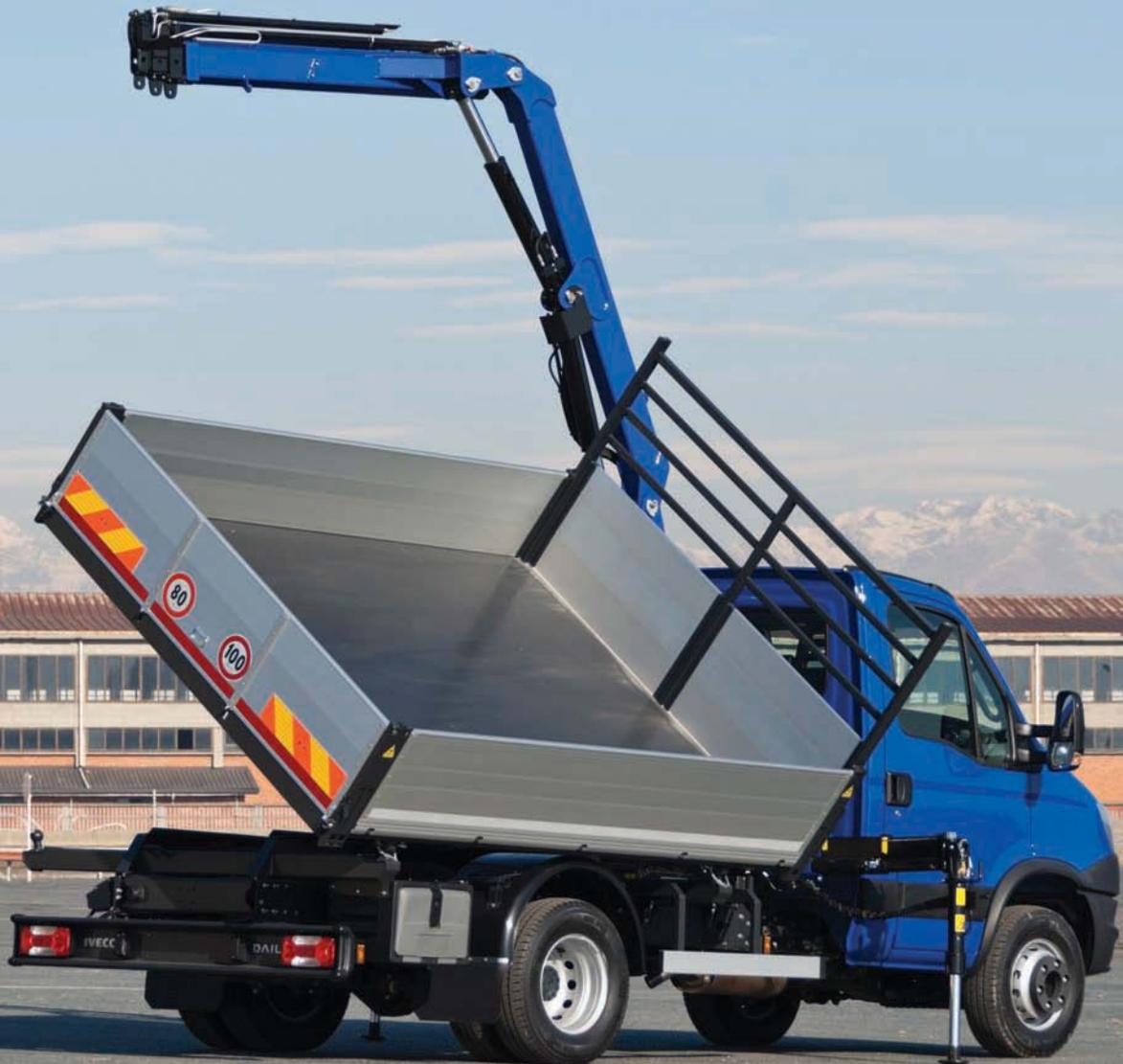
Niente è impossibile per Daily. Dopo aver estratto gli stabilizzatori, riesce perfino a far sbracciare la gru retrocabina verso un lato e a scaricare il cassone su quello opposto, dimostrando così l'elevata resistenza torsionale del suo robusto telaio da vero camion.
