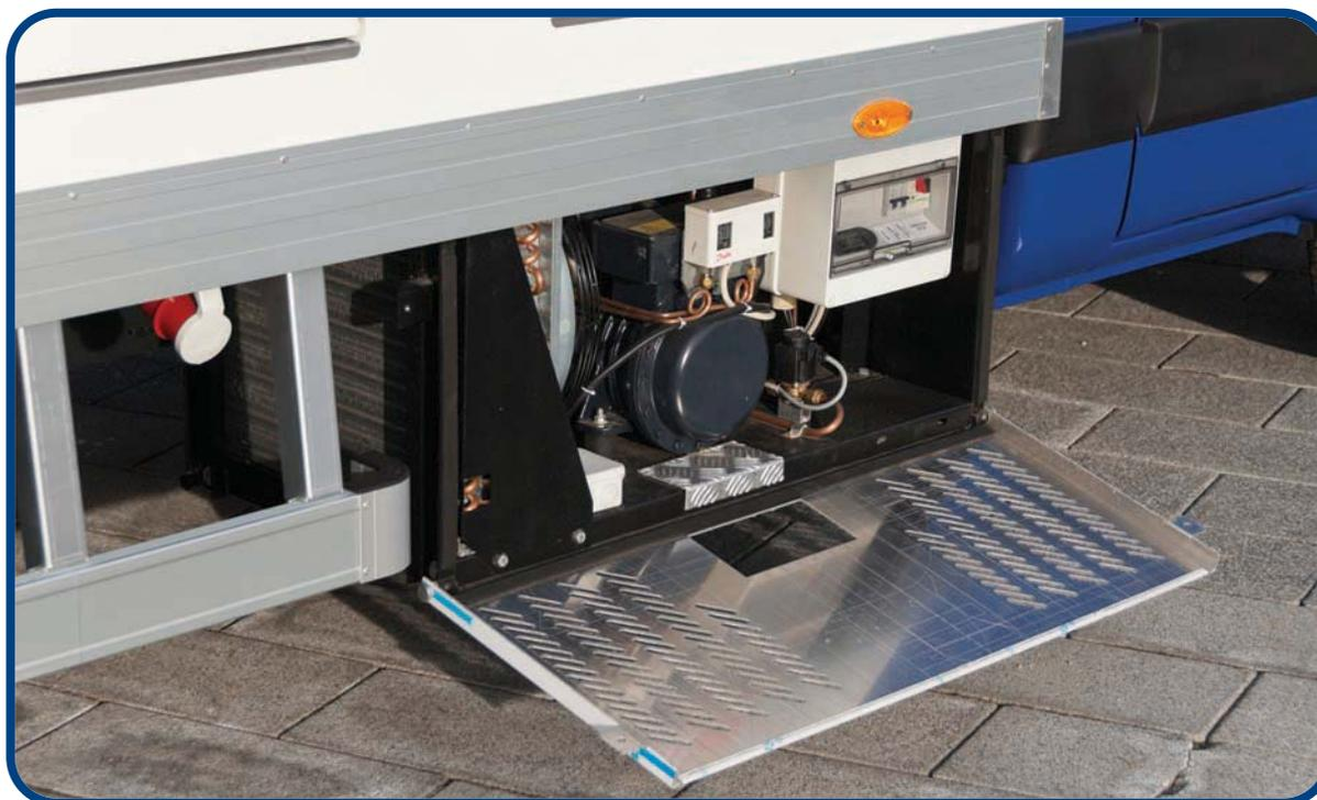
**Localizzato sul fianco passeggero del veicolo, appena alle spalle della cabina, il box che ospita un gruppo incaricato di refrigerare le piastre eutettiche montate nel box frigo. Più a sinistra, la presa per collegarlo alla rete elettrica.**
