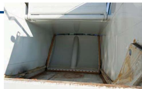
Sul fondo, la paratia semovente d'espulsione all'interno della vasca in acciaio Fe 360 da 6,8 metri cubi di capienza (foto sopra). A sinistra, i raccordi idraulici nascosti dietro la cabina.
