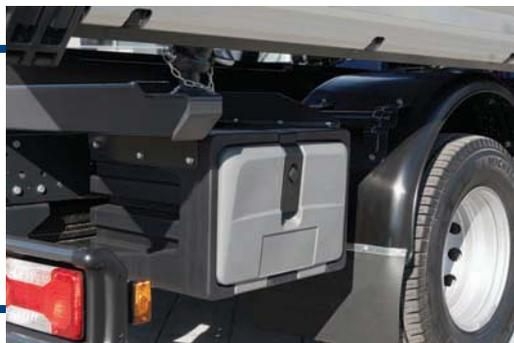
**Dall'estrema sinistra, una delle due zampe utilizzate per stabilizzare il veicolo durante le operazioni con la gru retrocabina e il box portattrezzi in sintetico fissato sottotelaio in coda al lato passeggero.**
