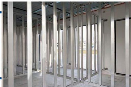
**All'estrema sinistra, il particolare della grondaia che previene il gocciolio all'interno del vano di carico. Suddiviso in otto celle simmetriche per mezzo di 'staccionate' in alluminio (foto a lato).**
