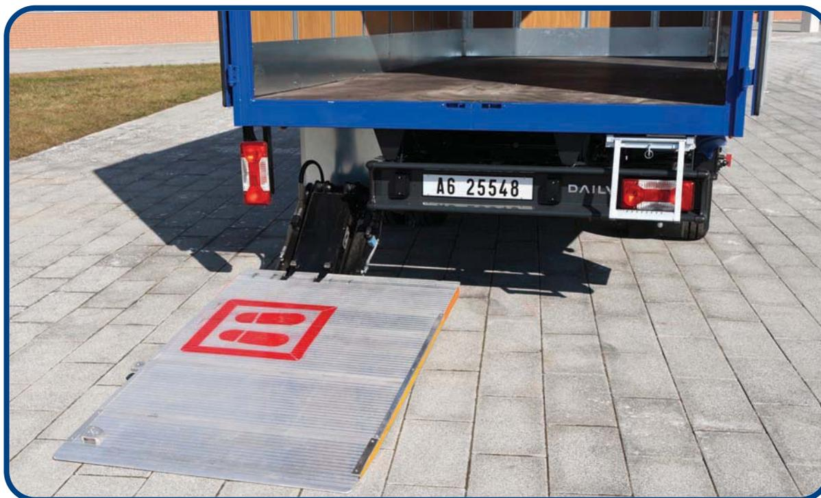
La mezza sponda posteriore a battente, con portata di ben 500 chilogrammi, consente di caricare e scaricare in un baleno senza fatica. Il gradino sul lato opposto alla sponda facilita invece l'ingresso nel vano di carico del personale addetto.
