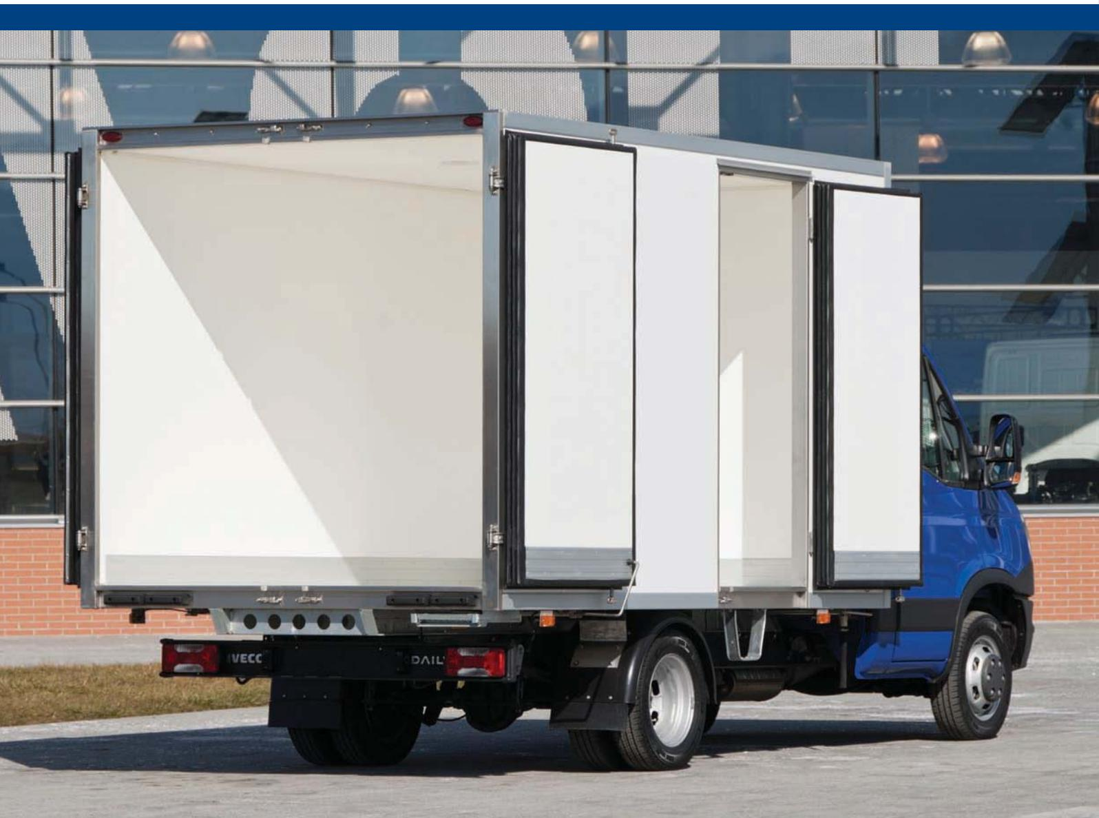
Realizzato in sandwich sintetico, il box ha al proprio interno un'ampia plafoniera tonda ancorata al cielo. La testata anteriore dell'allestimento è predisposta per l'installazione d'un eventuale gruppo frigo. Sotto il pianale, sono previsti dei fermaporta a molla.
