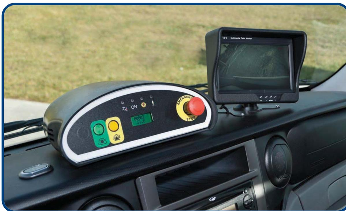
La console stondata, fissata sopra la plancia, in cui sono ospitati i comandi che servono a governare l'intera attrezzatura. Più a destra, il monitor lcd collegato a una telecamera che vigila in continuo tutte le operazioni sul retro del compattatore.
