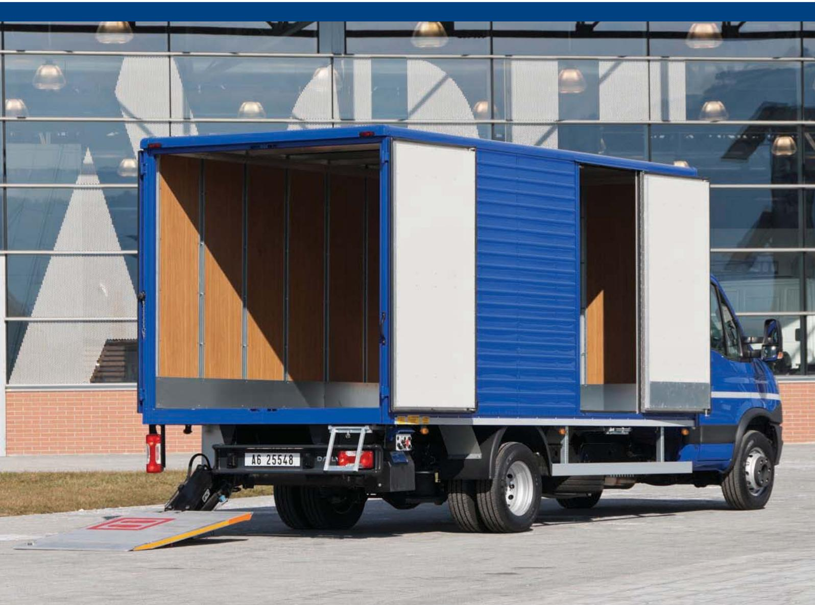
Le porte posteriori a doppio battente si aprono di ben 270 gradi, per terminare quindi radenti alle fiancate. Sul lato destro del vano di carico, è prevista una seconda porta singola con apertura classica: sotto la sua soglia, una scaletta estraibile.
