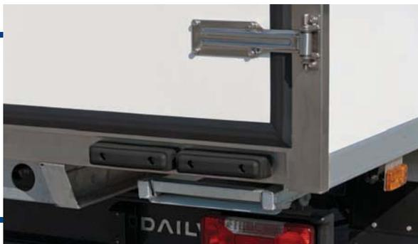
All'estrema sinistra, la chiusura perfettamente incassata delle tre porte previste. Qui a lato, un particolare dei tamponi posteriori d'appoggio in gomma e la scaletta retrattile sottoscocca.
