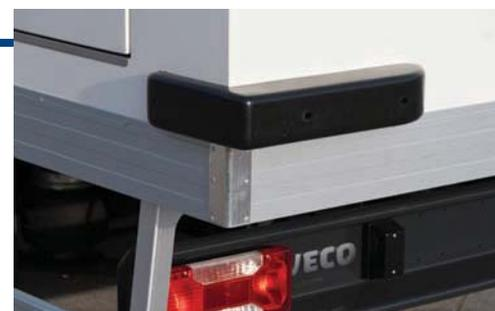
**Curato nei minimi dettagli, l'allestimento sfoggia delle luci d'ingombro a led (foto a sinistra) e degli angolari in sintetico a protezione degli spigoli, a rischio durante le manovre.**
