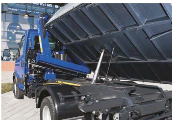
**Nella foto sopra, in evidenza, le nervature del cassone e il cilindro idraulico che si occupa dei movimenti trilaterali del cassone stesso. Ben visibile anche il controtelaio.**
