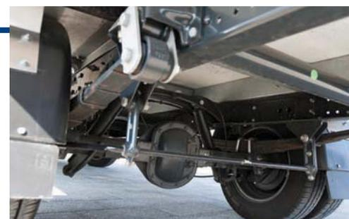
Sopra, il retrotreno gemellato dotato di sospensioni semiellittiche a quattro lame. A lato, un dettaglio della guarnizione pressoché ermetica prevista su tutte le porte.
