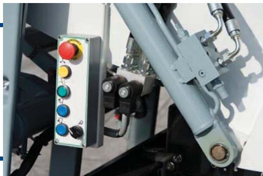
All'estrema sinistra, il retro del compattatore con le 'fauci' meccaniche completamente spalancate. Qui a lato, il pannello comandi esterno del voltacassonetti, localizzato in coda al lato destro.
