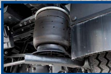
**Sospensione a ruote indipendenti con barra di torsione o balestra trasversale più ammortizzatori telescopici idraulici per l'avantreno. Sul ponte si può scegliere fra balestre - paraboliche o semiellittiche - (qui a lato) o sospensioni pneumatiche (sopra a destra). Queste ultime sono l'ideale per chi trasporta merci delicate: migliorano l'assorbimento delle vibrazioni e garantiscono l'allineamento orizzontale del veicolo a prescindere dalla distribuzione del carico.**
