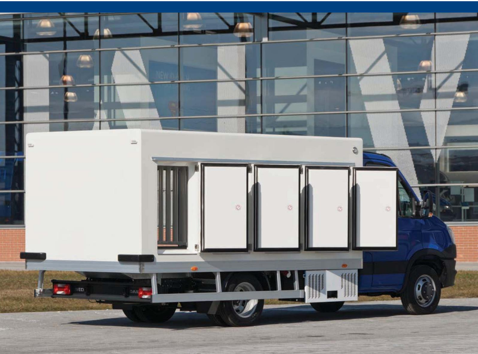
L'allestimento frigo di Daily utilizza pannelli sandwich in poliuretano pre-espanso e offre, su ciascun lato, ben quattro sportelli con doppie guarnizioni che non necessitano di resistenze. Il gruppo, montato sottoscocca, sfrutta un gas refrigerante ecologico R 404 A.
