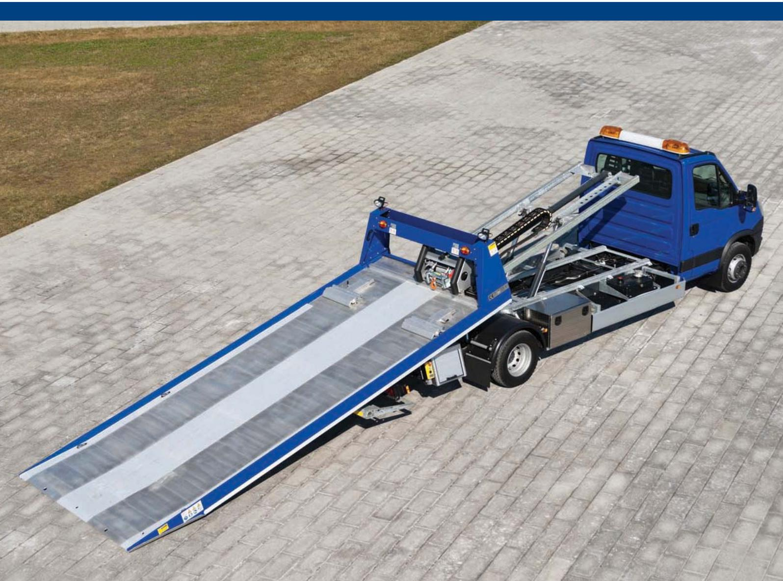
Quasi una piattaforma completamente scarrabile, così da ridurre al minimo la pendenza nelle operazioni d'imbarco e sbarco dei veicoli. L'ideale quindi anche per autovetture sportive con angoli d'attacco minimi, causa assetti ribassati o appendici aerodinamiche.
