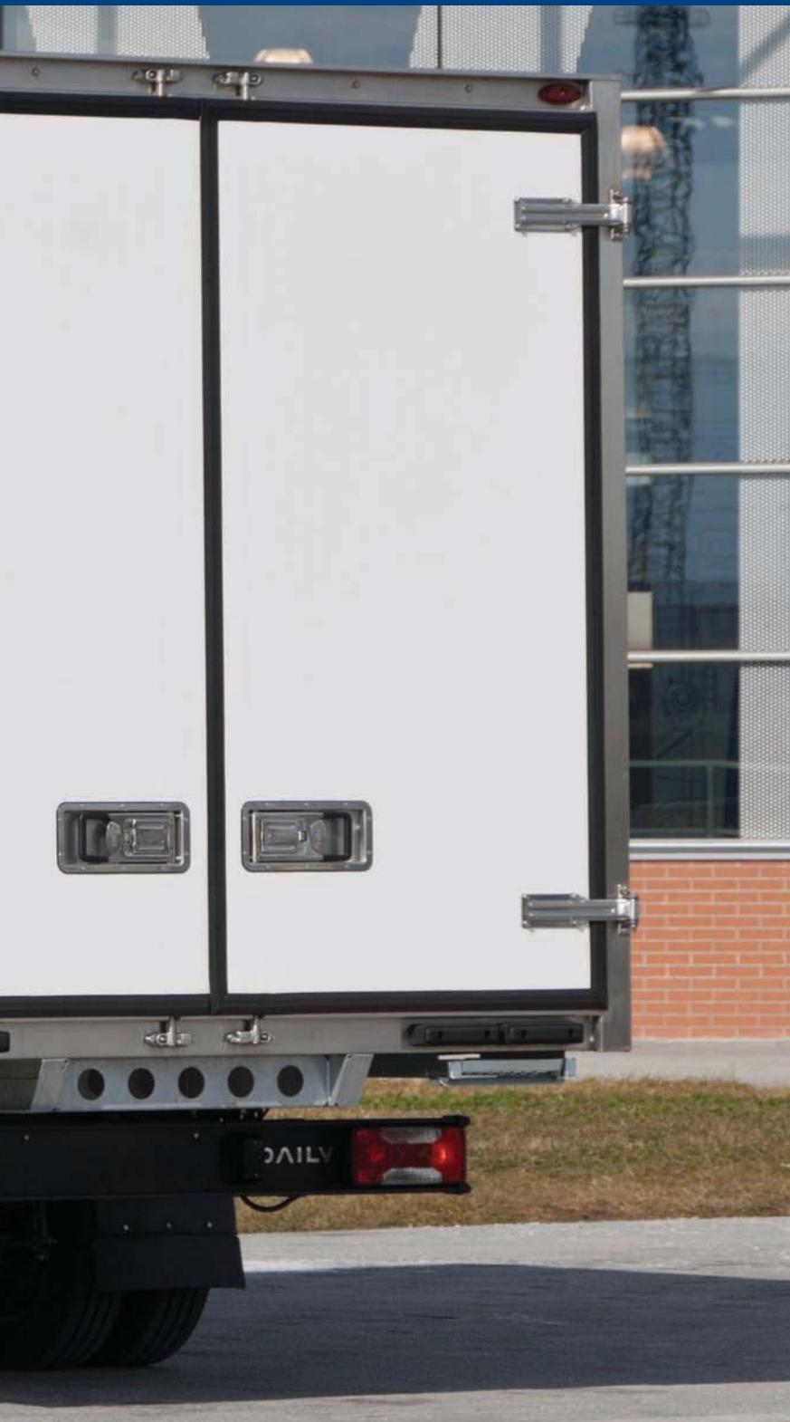
**I prodotti freschi**, che non necessitano però di refrigerazione continua, spesso viaggiano in box isotermitici, magari all'interno di speciali contenitori isolanti. Pur senza un gruppo frigo (talvolta installabile anche a posteriori) né piastre eutettiche, è così possibile effettuare in tranquillità il giro quotidiano di consegne dei deperibili.
