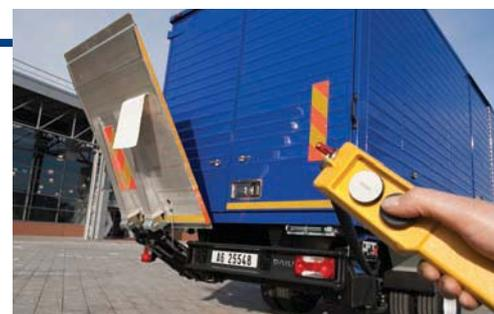
Un telecomando senza fili controlla la sponda a distanza. Sulla sinistra, l'interno del furgone rivestito in laminato e con centine d'alluminio dotate di punti per il fissaggio del carico.
