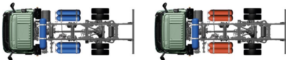
Réservoirs des deux côtés et derrière la cabine
